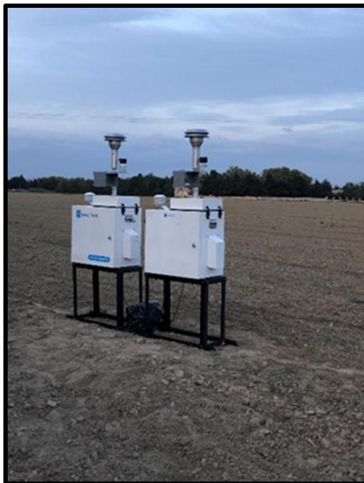
Figure 125. Illustration d'un préleveur séquentiel dichotomique et de tubes passifs
